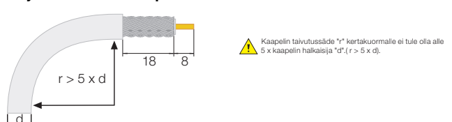
Kuva 1: Kuorintapituus antennirasialle
