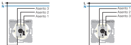
Kuva 1: 3-askelkytkin nolla-asennolla [Tyyppi 3861] / 3-askelkytkin ilman nolla-asentoa [Tyyppi 386101]
