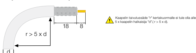
Kuva 1: Kuorintapituus antennirasialle
