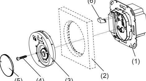
Bild 1: Geräteaufbau
