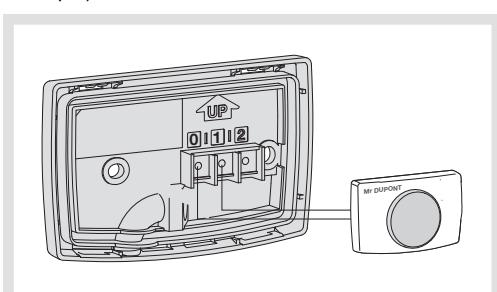
**Extension d'une installation filaire existante avec raccordement sur transformateur de sécurité (bornes 0 et 2)**
