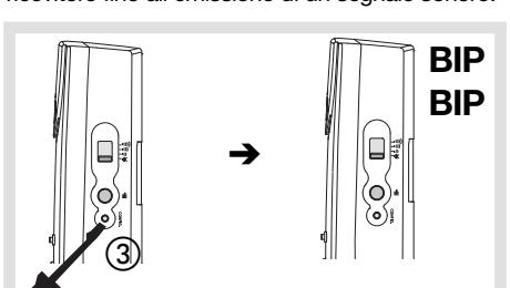
Premete il tasto di configurazione **A** del trasmettitore che volete escludere. Il ricevitore emetterà un segnale sonoro ripetuto. Il ricevitore ha allora azzerato il suo link con il trasmettitore.
