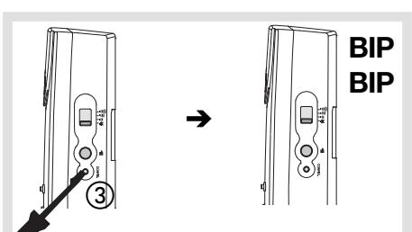
Appuyez sur le bouton de configuration **(A)** de l'émetteur que vous voulez dissocier. Plusieurs "bip" sont émis par le récepteur. Le récepteur a effacé le lien avec l'émetteur.
