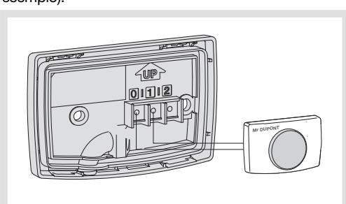
**Estensione di un'installazione filare esistente con collegamento all'trasformatore di sicurezza (morsetti 0 e 2)**
