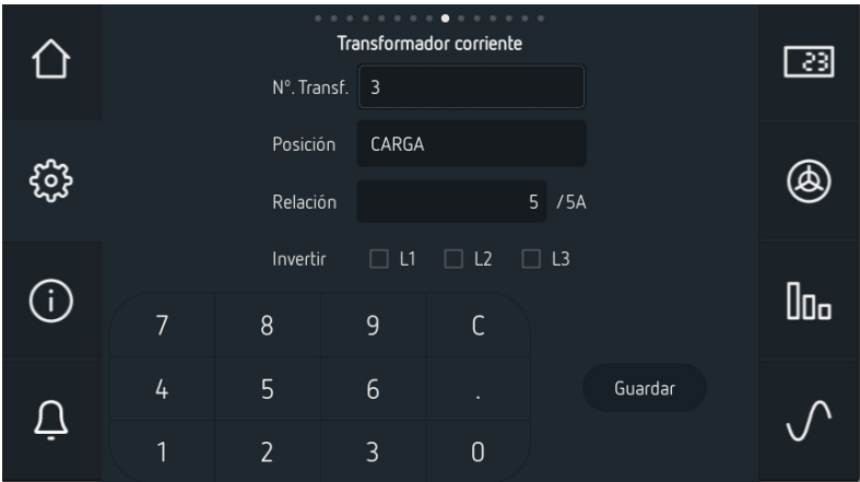
Figura 88: Pantalla de configuración: Transformador de corriente.
