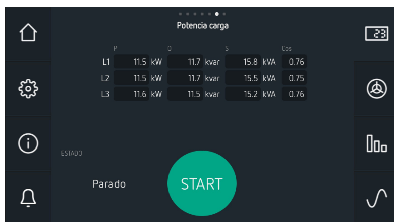
Figura 58: Visualización de la potencia y cos \phi de la carga.
