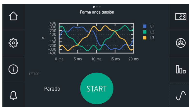
Figura 67: Forma de onda de la tensión.
