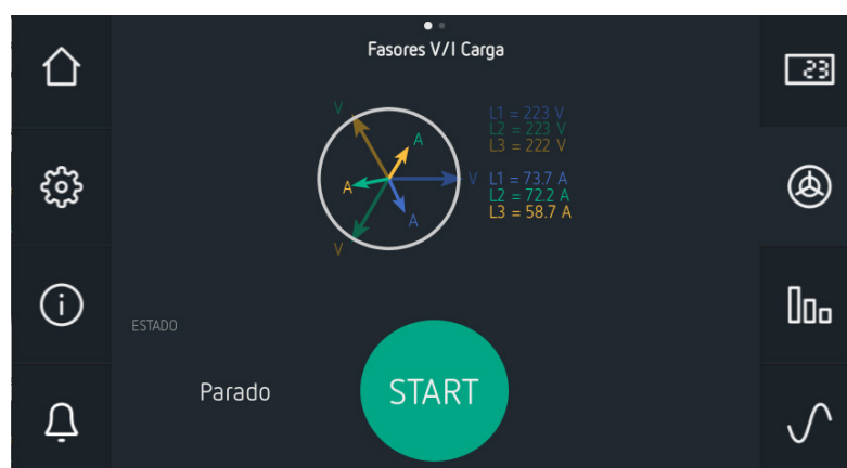
Figura 62: Fasores de Carga.
