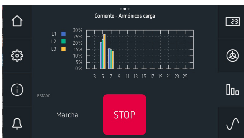
Figura 65: Visualización de los armónicos de la corriente de carga.
