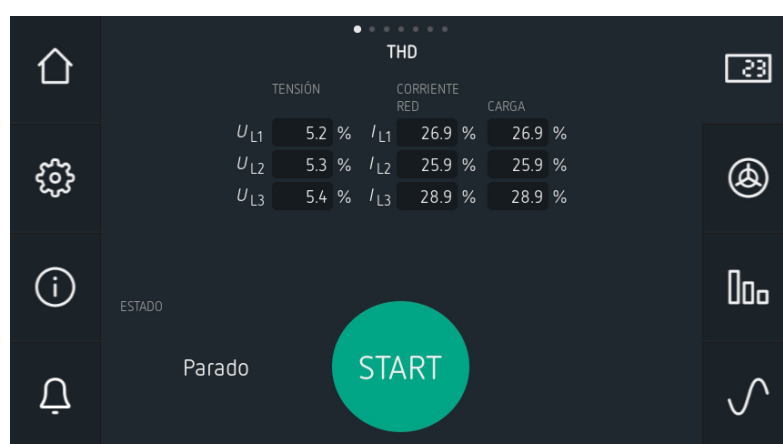
Figura 52: Visualización del THD.
