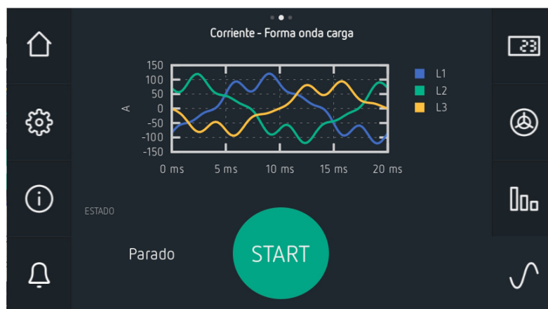
Figura 68: Forma de onda de la corriente de Carga.
