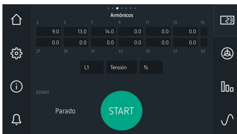
Figura 55: Visualización de la tabla de armónicos.
