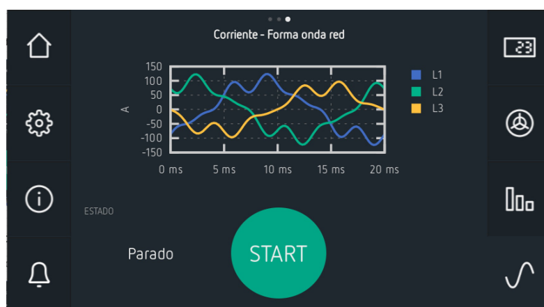
Figura 69: Forma de onda de la corriente de red.
