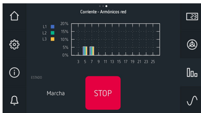
Figura 66: Visualización de los armónicos de la corriente de red.
