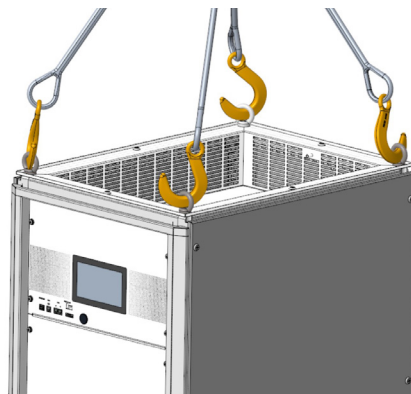
Figura 3: Transporte de un armario AFQm mediante grúa.
