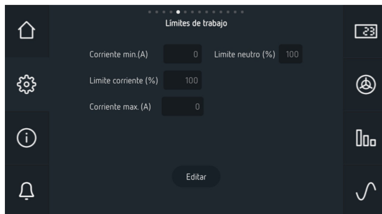
Figura 84: Pantalla de configuración: Límites de trabajo.
