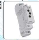
CRM-61 6 toimintoa, 6 aika-alueita, 1x8A vaihtokosketin, syöttö 24-240VAC, 24VDC
